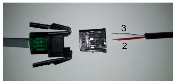
Anschluss des Temperatursensorkabels Kabel mit Anschlüssen 2 und 3 verbinden. 1 = Bleibt unbesetzt 2 = Rot 3 = Weiß
