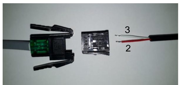
Lämpötila sensorin kaapelien kytkentä
