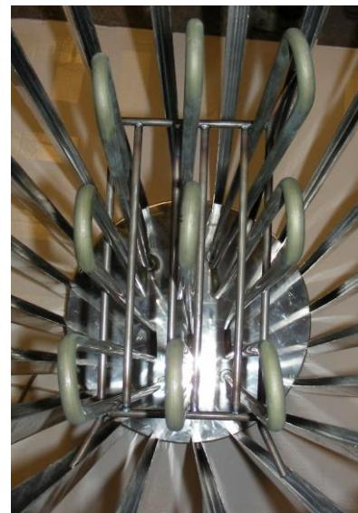
Poussez les pivots à une extrémité du support dans les fentes des traverses verticales.
