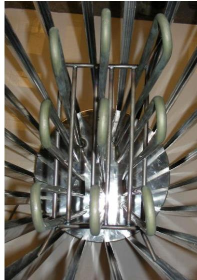
Zamáčkněte čepy na jednom konci podpěry do drážek ve vertikálních paprscích.
