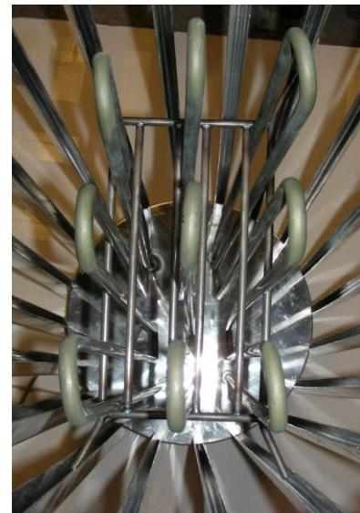
Presione los pivotes del extremo del soporte hacia las guías de las vigas verticales de las resistencias.
